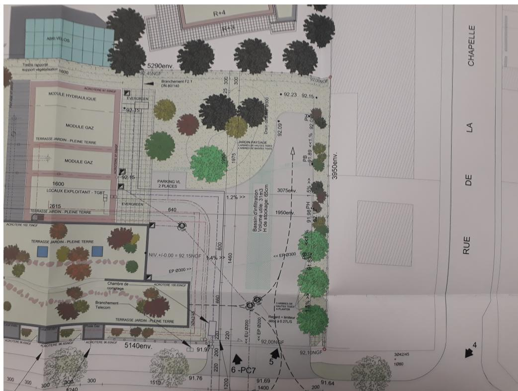
On remarque sur le plan ci-dessus la signalétique en pointillé montrant les trajets des camions venant de l'extérieur et manœuvrant à l'intérieur du terrain de la chaufferie.
